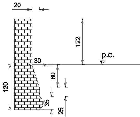
Figura 2 Schizzo fondazioni rilevate dai saggi S1 ed S2. Le quote sono riportate in centimetri
