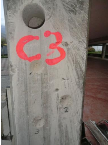
Pull out 1 e 2 rispettivamente nei pilastri P07 e P120 del piano terra
