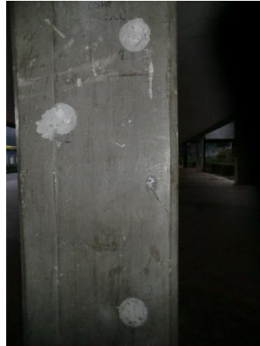
Pull out 1 e 2 rispettivamente nei pilastri P07 e P120 del piano terra
