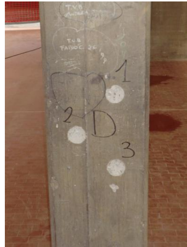
Pull out 3 e 4 rispettivamente nei pilastri P03 e P16 del piano terra
