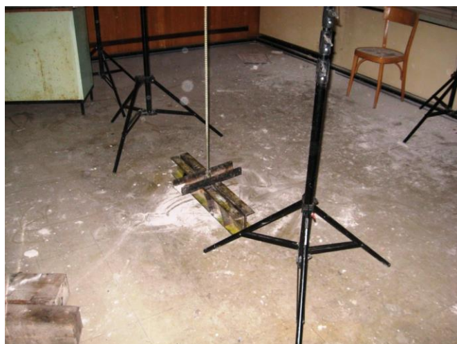
Prova n°6 – Ripartitore di carico
