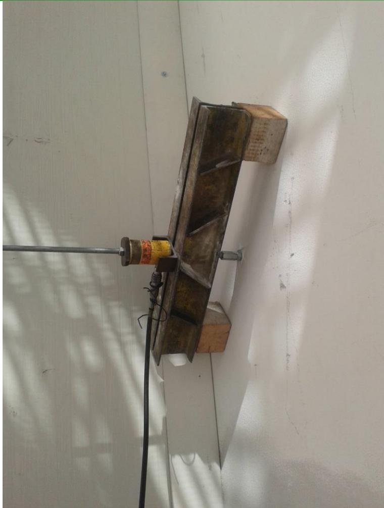
Prova n.1 di estrazione su M16 da muratura in ca
